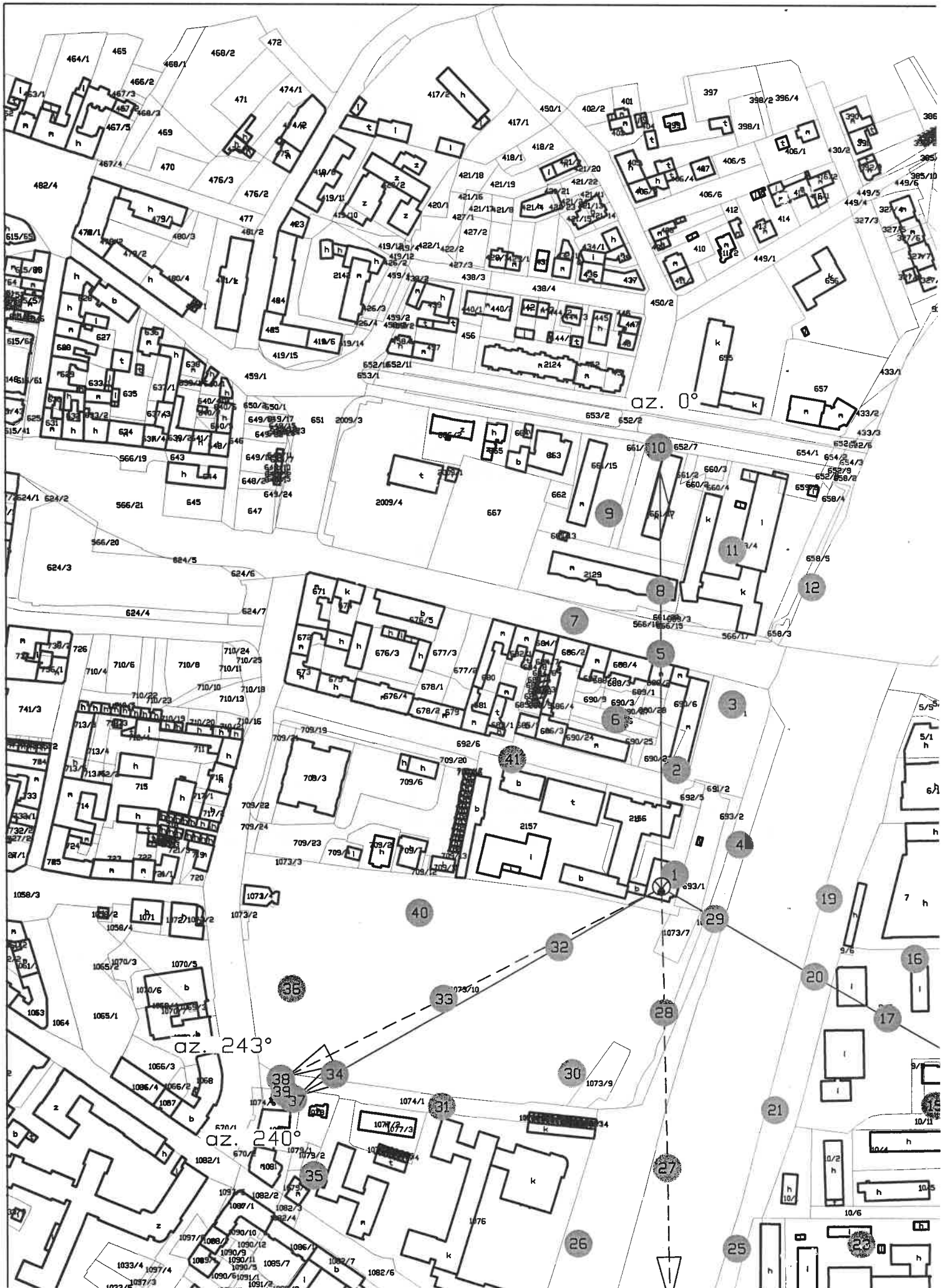
Rys.1 Lokalizacja pionów pomiarowych
